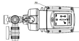
Die im Lieferumfang enthaltene Verrohrung mit Absperrventilen, Manometer und Probeentnahmeventil ermöglicht eine einfache Überprüfung und Kontrolle der Station.
